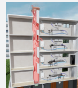
Conduits « Shunt » 650 000 chaudières
