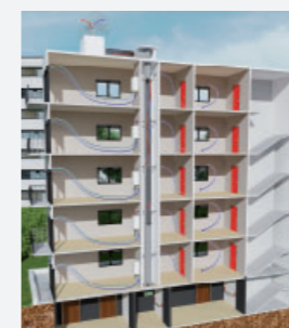
Conduits « VMC gaz » 780 000 chaudières
