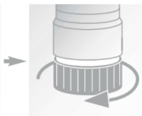
Si la pression lue au manomètre est inférieure à 1 bar, remplir l'installation en ouvrant le robinet bleu placé sous la chaudière jusqu'à obtenir 1,5 bar.
